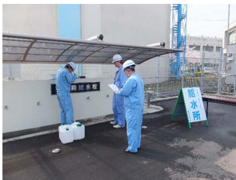
～災害時給水栓の水質試験～
