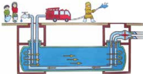
耐震性貯水槽
