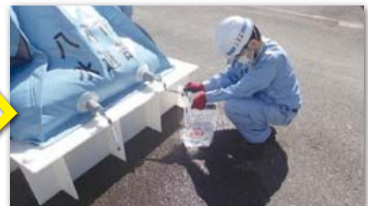
▲給水している様子 2か所の蛇口から給水することができます
