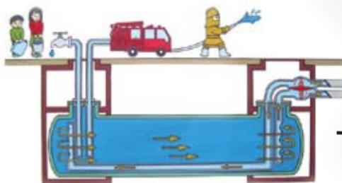
普段は水道管と直結していて、貯水槽内で常に水が循環しています。地震が発生すると弁が自動的に閉まり、100立方メートル(1人あたりに必要な1日3リットルの飲料水約3万3千人分)の水を確保することができます。
