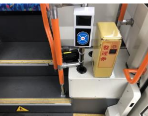
▲後扉付近の赤外線センサー
