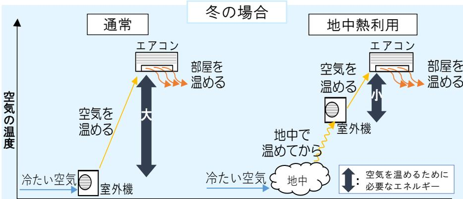
温度が安定している地中(常に約15℃)を通して温まった空気を室外機に取り込むので、外気を直に取り込む場合よりも温めるためのエネルギーを節約できるんだね。
