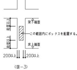
2-3) ボックス類取り付け部の補強要領(図-4)
