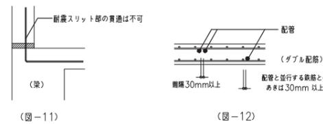
(5) ダブル配筋壁の場合はアウトレットボックス廻りを除き、内外の鉄筋側に配管する。
