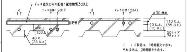
\* アウトレットボックス等を埋設する場合はボックス面に対して所定の被り厚さを確保し、ボックスの外形+100mmの範囲に耐火被覆を施すこと。
