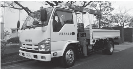
災害時などにも使用するクレーン付き車両
