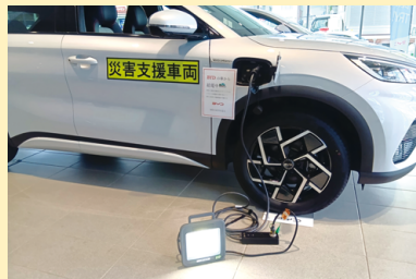
電気自動車からの電力供給の様子
