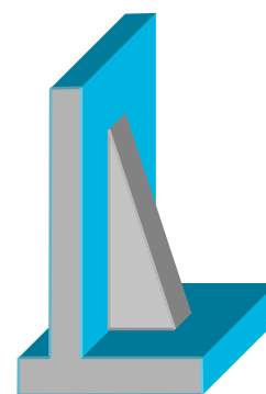
控え壁式擁壁
