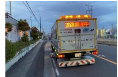
空洞探査車による調査(1次調査)
