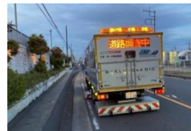
空洞探査車による調査(1次調査)
